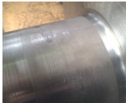
Рисунок 10 - Следы электроэрозии на шейке ротора турбины
