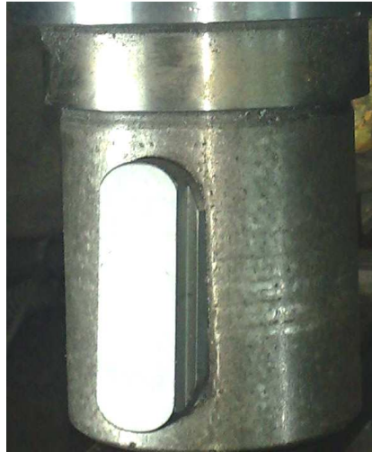
Рисунок 8 - Устранение последствий электроэрозии
