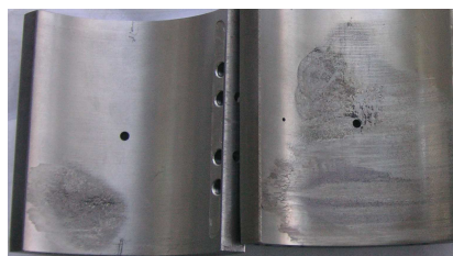
Рисунок 3 - Электроэрозионное разрушение опорных колодок подшипника
