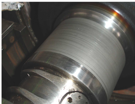
Рисунок 9 - Следы электроэрозии на шейке ротора турбины
