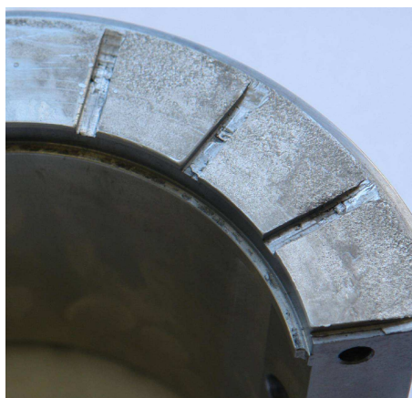
Рисунок 4 - Электроэрозионное разрушение упорной поверхности опорно-упорного подшипника
