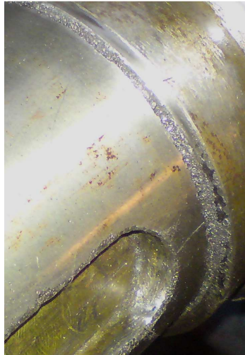
Рисунок 7 - Электроконтактная эрозия шпоночного паза
